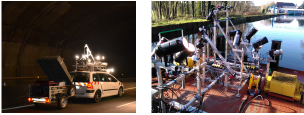
FIGURE 2 – Système de prises de vues du Cerema monté sur une automobile (à gauche) ou un bateau (à droite) pour l’acquisition d’images en tunnels routiers ou navigables
